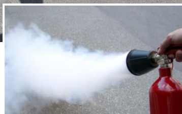
På 2 kg släckaren sitter munstycket monterat direkt i ventilen
