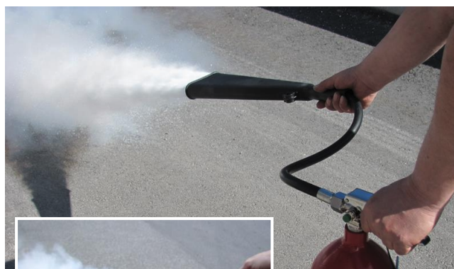
5 kg släckaren har en slang så att släckmedlet enkelt kan spridas över större ytor.
